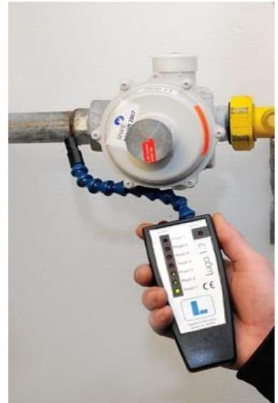
Der LugaBlue wird unter dem Logo eingetastet. Das Gerät braucht einige Sekunden um den Sensor auf die passende Betriebstemperatur zu bringen. Ein kurzer Signalton gibt die Messung nach dem Einschalten frei. Das Messgerät wird durch eine 9 Volt Batterie betrieben. Unten Rechts im Display ist ein Batteriesymbol, an dem sie den Ladezustand sehen können. Erst gibt es einen Warnhinweis, danach schaltet das Gerät ab. Auf der Gehäuse-Unterseite, öffnen Sie die Klappe und wechseln den 9 Volt Block aus.
